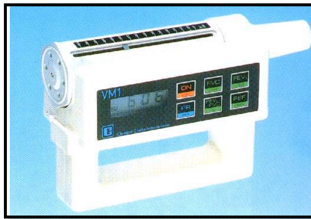
Fig 7 Miniexpirômetro Enhance VMI®. Na porção superior encontra-se um miniventilômetro de Wright, situado no mesmo eixo do bocal por onde o paciente deverá assoprar para se aferir, inicialmente, o PFE. Com a simples manobra da CVF, é possível determinar outras funções pulmonares, como FEV 1 e o índice de Tiffeneau (FEV 1 /CVF). Os valores são registrados imediatamente num display. Para solicitar as avaliações respiratórias, basta apertar os comandos correspondentes, localizados, lateralmente, à esquerda do expirômetro.
