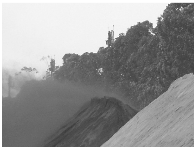
Figura 1.4 – Processo de erosão de uma pilha de material estéril. Fonte: Loredou-Souza et al (2006).
