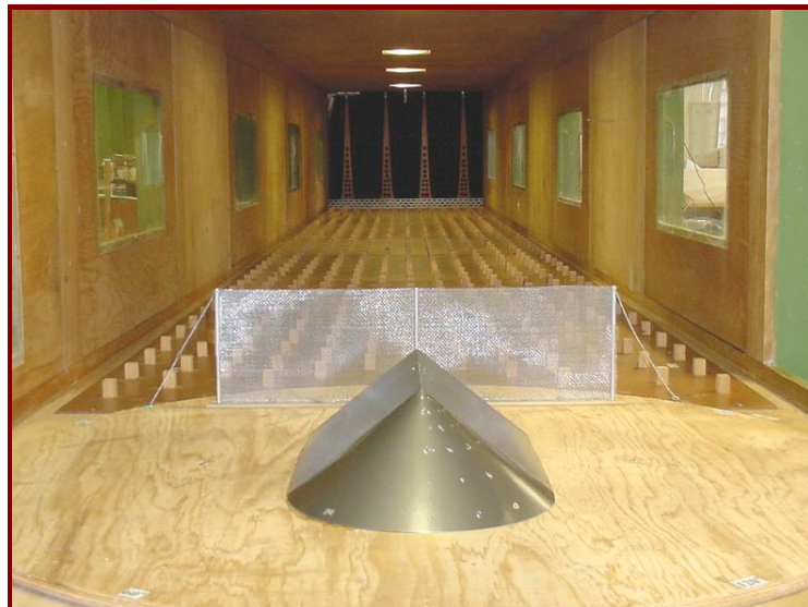
Modelo da pilha de carvão isolada no interior do Túnel de Vento com anteparo tipo K ( \epsilon = 68\% ), altura S (1,5H).
