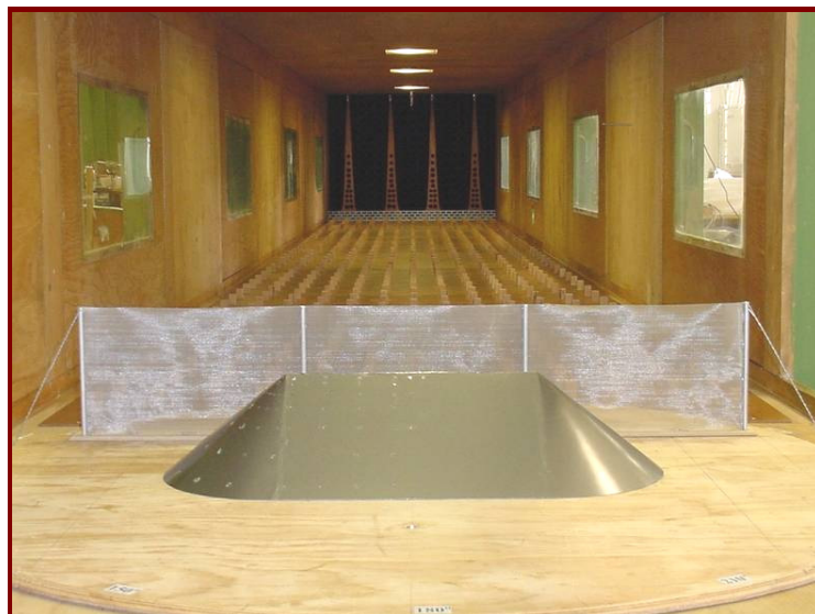
Modelo da pilha de carvão isolada no interior do Túnel de Vento com anteparo tipo N ( \epsilon = 37\% , fio 0,01mm ), altura S (1,5H).
