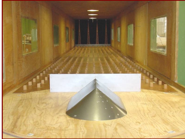
Modelo da pilha de carvão isolada no interior do Túnel de Vento com anteparo tipo O ( \epsilon = 0\% - placa sólida), altura R (1H).
