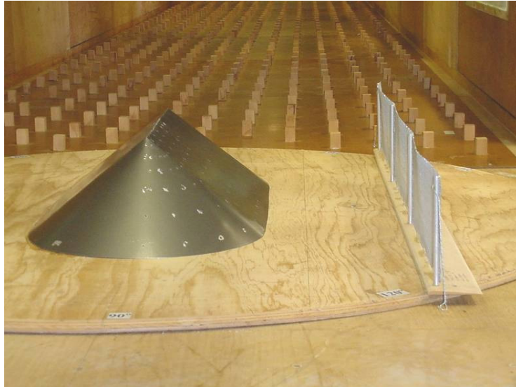
Modelo da pilha de carvão isolada no interior do Túnel de Vento com anteparo genérico, altura R (1H) e afastamento Y (1,5H).
