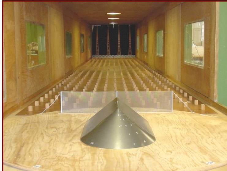
Modelo da pilha de carvão isolada no interior do Túnel de Vento com anteparo tipo L ( \epsilon = 53\% ), altura R (1H).
