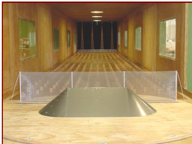
Modelo da pilha de carvão isolada no interior do Túnel de Vento com anteparo tipo L ( \epsilon = 53\% ), altura S (1,5H).
