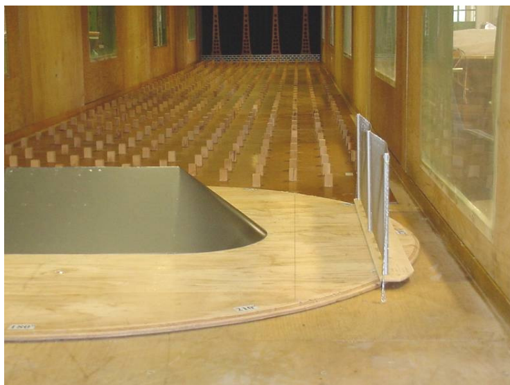
Modelo da pilha de carvão isolada no interior do Túnel de Vento com anteparo genérico, altura S (1,5H) e afastamento Y (1,5H).
