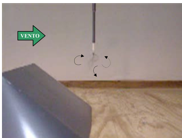
Figura 4.22 – Visualização do escoamento com haste flexível.
