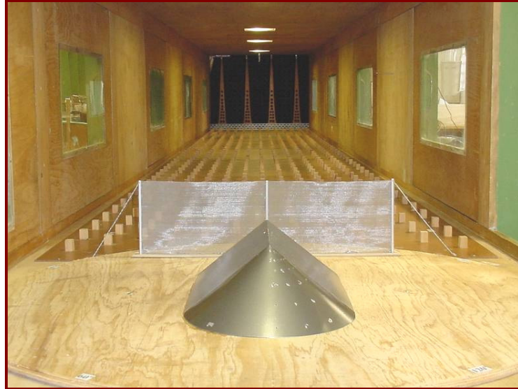
Modelo da pilha de carvão isolada no interior do Túnel de Vento com anteparo tipo N ( \epsilon = 37\% , fio 0,01mm ), altura R (1H).
