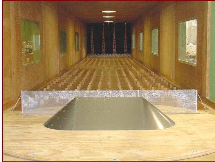
Modelo da pilha de carvão isolada no interior do Túnel de Vento com anteparo tipo K ( \epsilon = 68\% ), altura R (1H).
