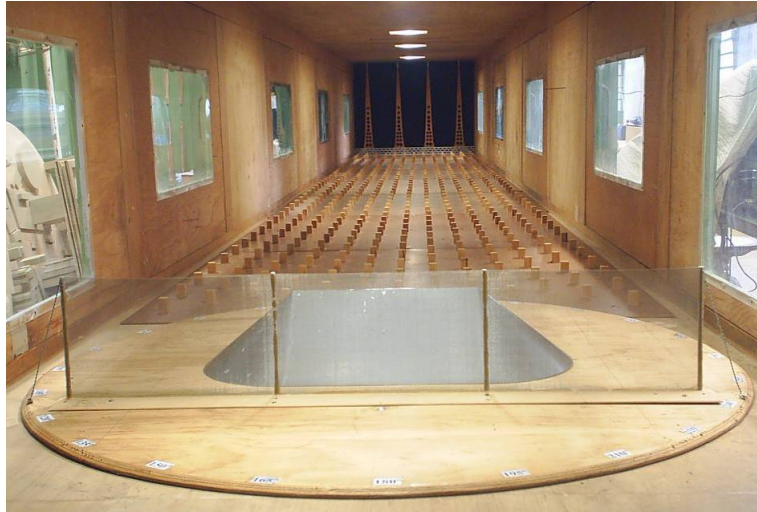
Figura 3.5 Ensaio do modelo com tela a sotavento (configuração EF MSX).
