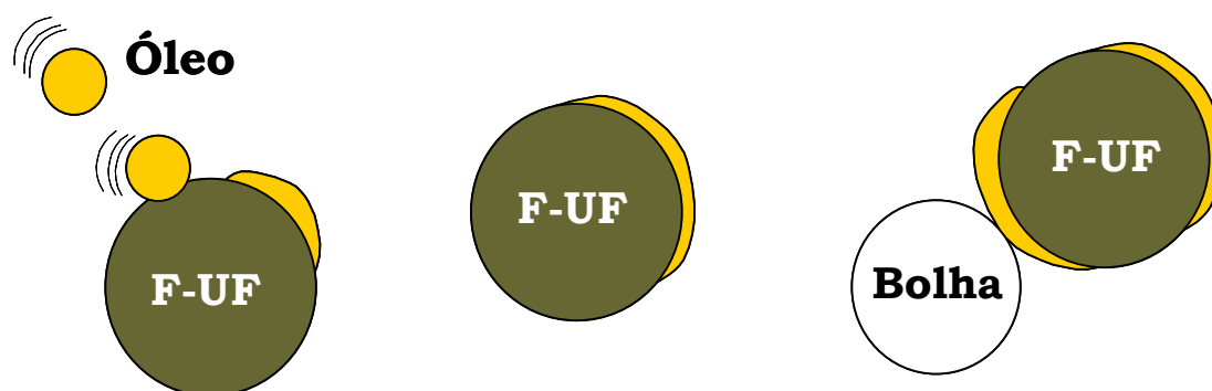
Figura 13. Fenômenos envolvidos no processo de flotação extensora ("extender flotation"): interação gota/partícula; espalhamento do óleo e formação de uma lente; adesão bolha/gota/partícula.
