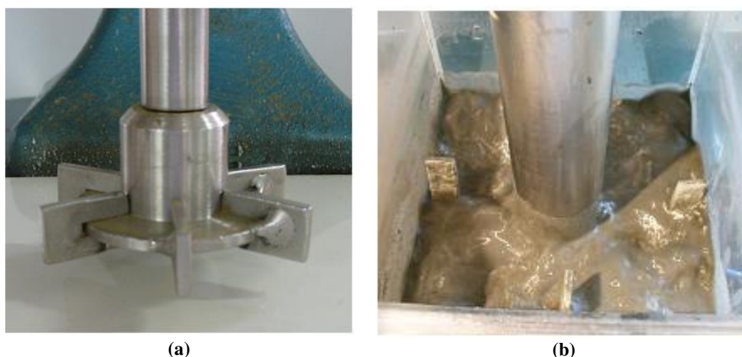
Figura 36. Fotos dos estudos de flotação com condicionamento em alta intensidade (CAI) com minério sulfetado de cobre. (a) Detalhe do impelidor tipo turbina Rushton de 6 aletas; e (b) detalhe do condicionamento com defletores (baffles).
