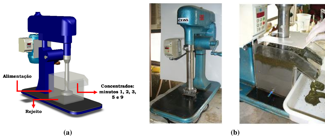
Figura 29. (a) Desenho esquemático do sistema utilizado; e (b) fotos da célula de flotação e detalhe da formação da camada de espuma nos estudos de com minério sulfetado de cobre.
