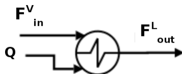
Figura 3.8: Modelo esquemático de um condensador estacionário.
