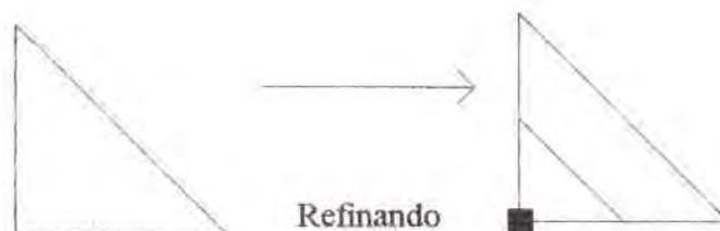
Figura 4.5 - Subdivisão usada para elementos triangulares.
