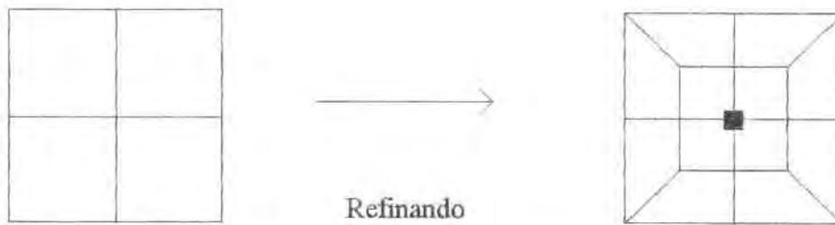
Figura 4.3 - Subdivisão usada para elementos quadriláteros.
