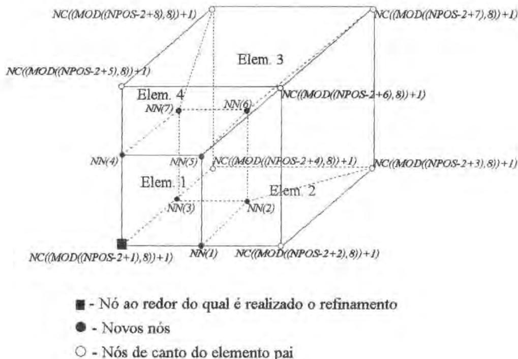
Figura 4.10 - Posição e numeração dos novos nós e elementos para elementos hexaédricos.
