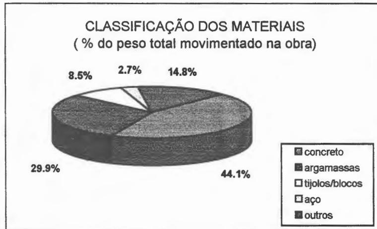
Figura 4.3 Classificação dos materiais pelo percentagem do peso movimentado na obra (LICHTENSTEIN, 1987)
