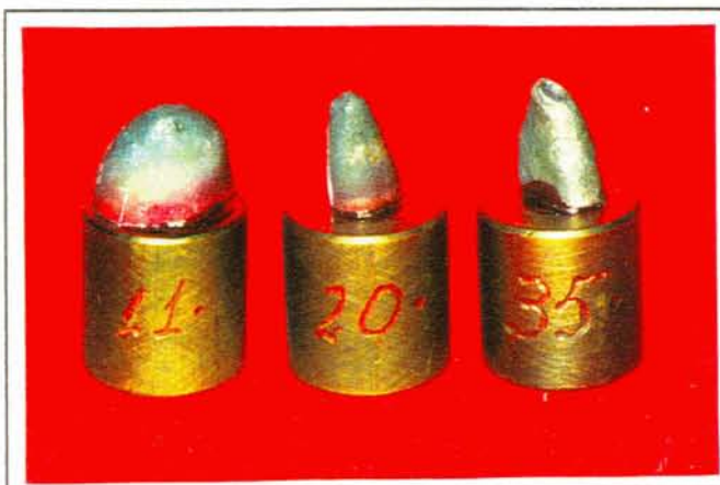
Figura 8 – Raízes montadas em "stubs" e metalizadas para microscopia eletrônica de varredura.
