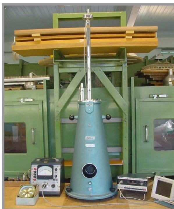
Figura 4.3: Micromanômetro a água tipo *Betz*.
