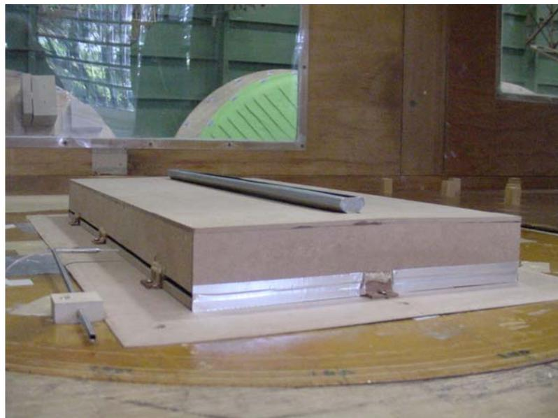
Figura 4.30: Fechamento das aberturas do modelo com fita de alumínio.
