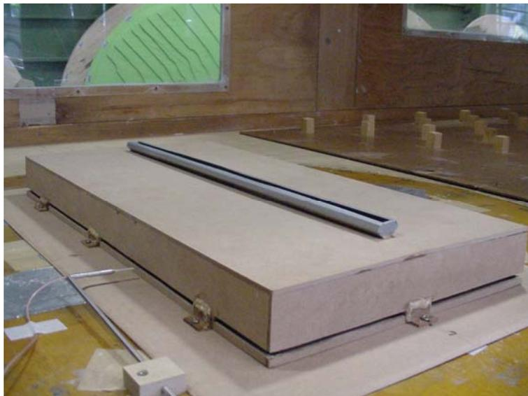
Figura 4.25: Modelo do pavilhão industrial com as aberturas livres para a passagem do escoamento.
