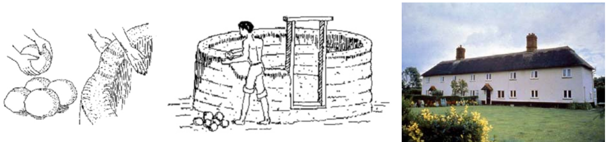
Figura 11: desenhos esquemáticos e exemplar de edificação em terra empilhada (MINKE, 2005, p. 87; CRATERRE, 2006)
