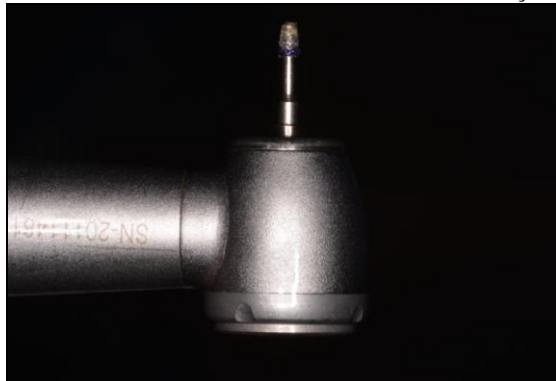
Figura 3 – Ponta diamantada tronco-cônica com a marcação em 2mm.
