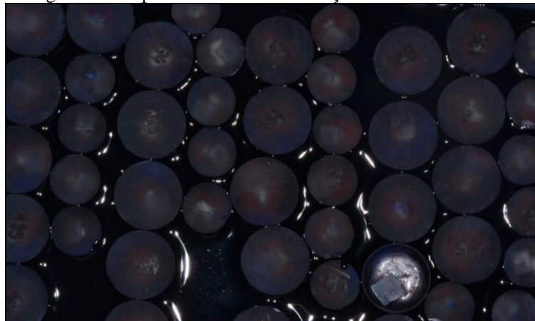
Figura 19 – Espécimes imersos em solução de azul de metileno.
