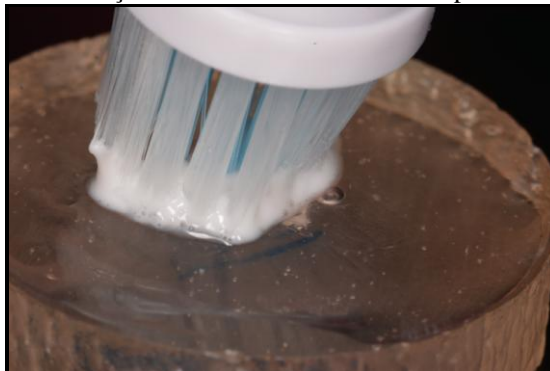
Figura 17 – Desafio abrasivo: escovação utilizando escova elétrica e pasta fluoretada com saliva artificial.
