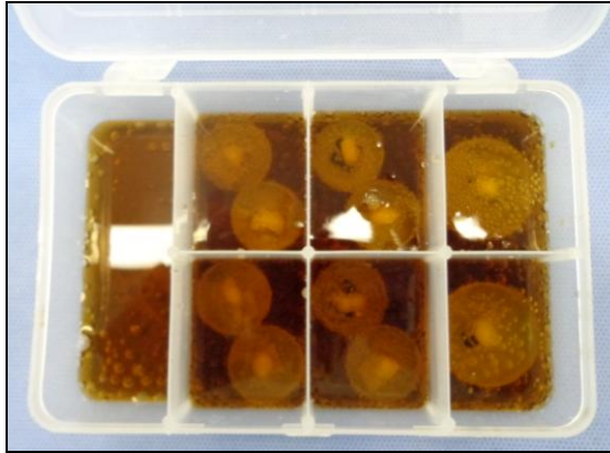
Figura 16- Desafio erosivo: imersão dos blocos restaurados em Coca-Cola.
