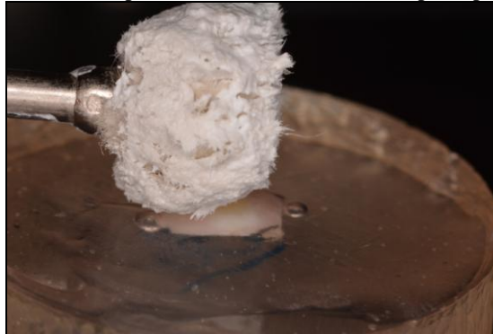
Figura 15 – Polimento superficial com disco de feltro e pasta para polimento.
