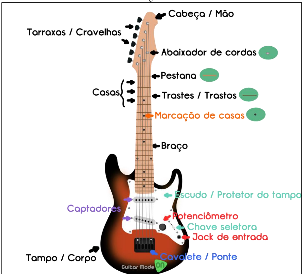
Partes de uma guitarra elétrica
