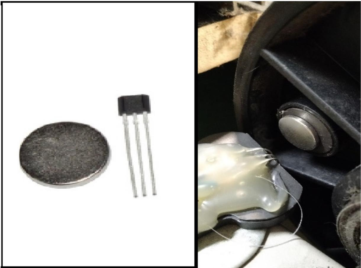
Figura 4.3: À esquerda figura adaptada do sensor e ímã avulsos; à direita o sensor e o ímã acoplados à esteira. Fonte: (NUNES, 2014)
