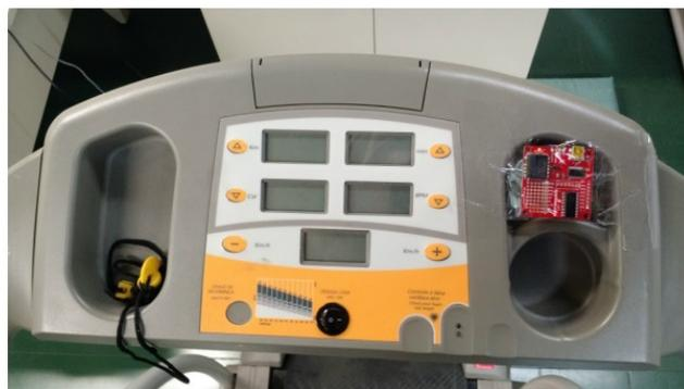
Figura 4.5: À esquerda a placa de detecção de ritmo cardíaco avulsa; à direita acoplada à esteira.
