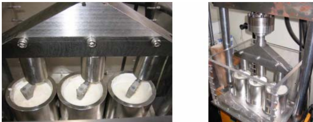
Figura 12. Dispositivos desenvolvidos para testar três próteses simultaneamente, montadas na máquina de fadiga.
