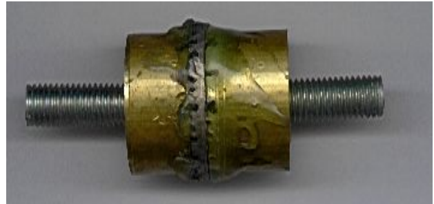
Figura 17b. Fotografia do corpo-de-prova com diâmetro de 28 mm feito da liga Ti-6Al-4V ELI, após o corte e preparação para ensaio de adesão.
