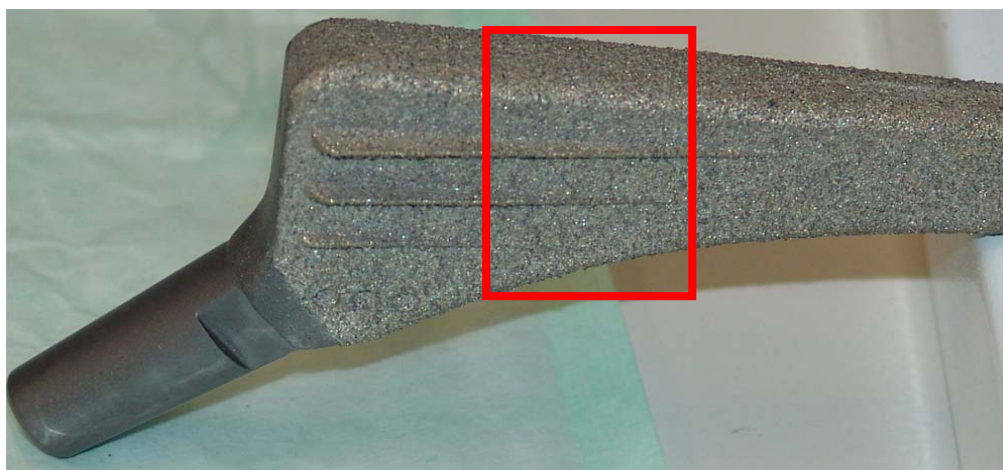
Figura 20. Fotografia da prótese não cimentada, Logical modelo 345.125 (Lote 702688) feita da liga Ti-6Al-4V ELI indicando a região do corte para o ensaio de adesão (Zona Estriada).
