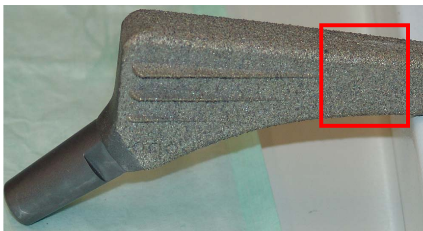
Figura 19. Fotografia da prótese não cimentada, Logical ® modelo 345.125 (Lote 702688) feita da liga Ti-6Al-4V ELI, indicando a região do corte para o ensaio de adesão (Zona Lisa).
