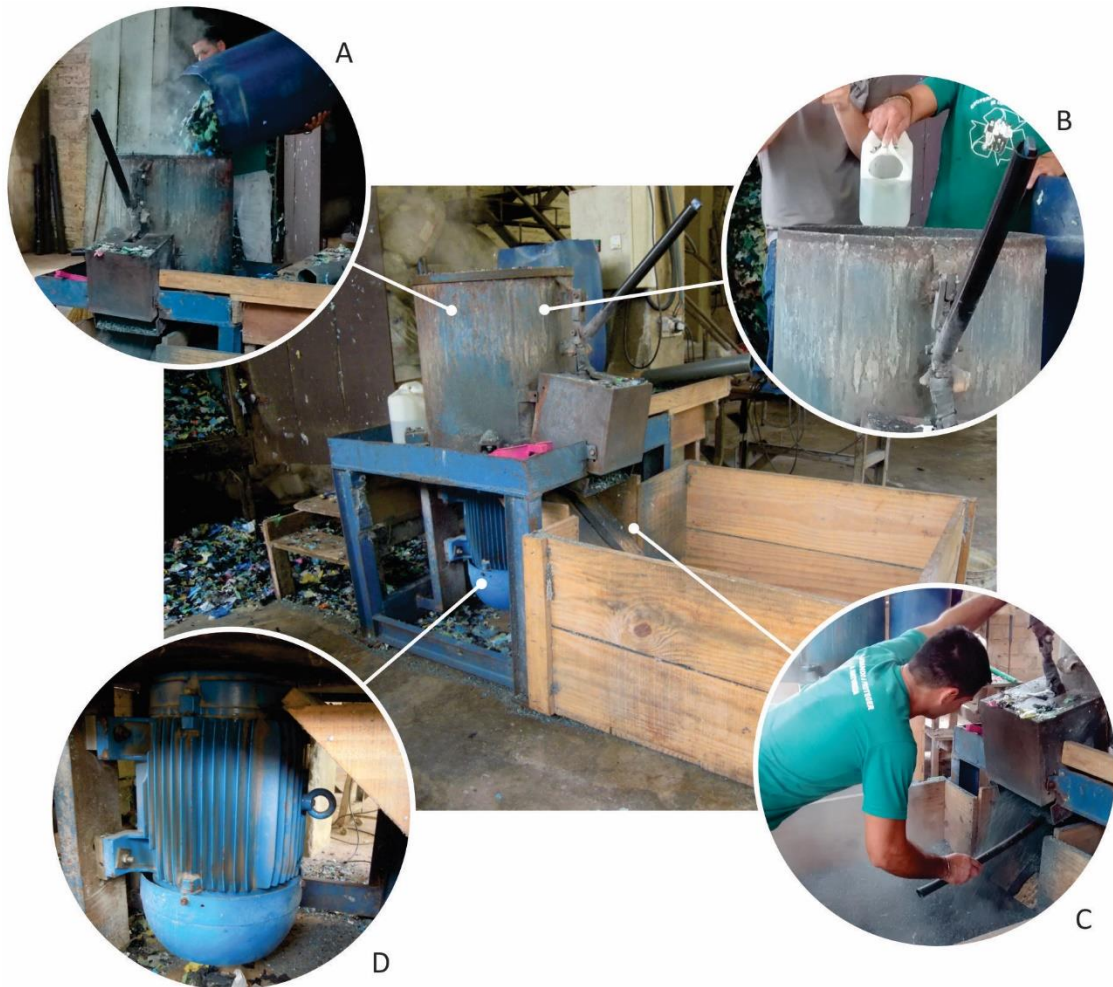
Figura 18 — Aglutinador analisado: (A) alimentação, (B) água, (C) saída e (D) motor
