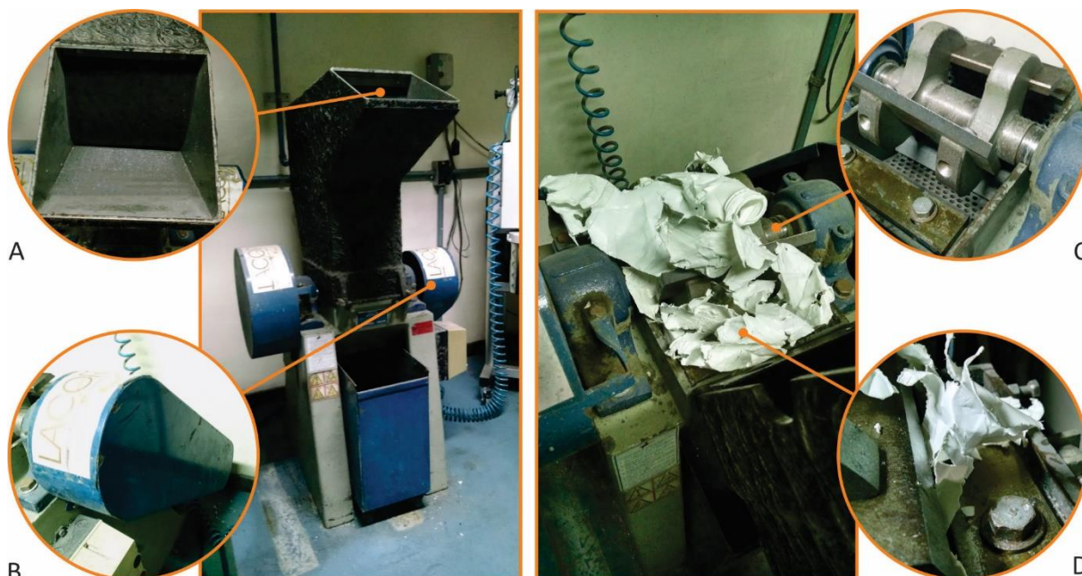
Figura 21 — Moinho do LACOR: (A) alimentação, (B) redução, (C) lâminas e (D) moagem
