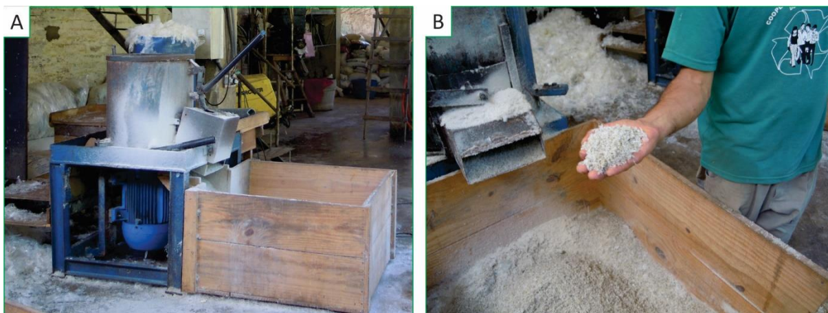
Figura 15 — Beneficiamento na Cooperativa: (A) aglutinador e (B) material processado
