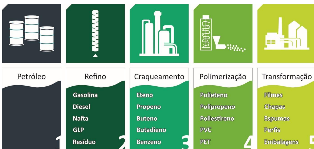
Figura 8 — Processo de fabricação de resinas termoplásticas a partir do petróleo
