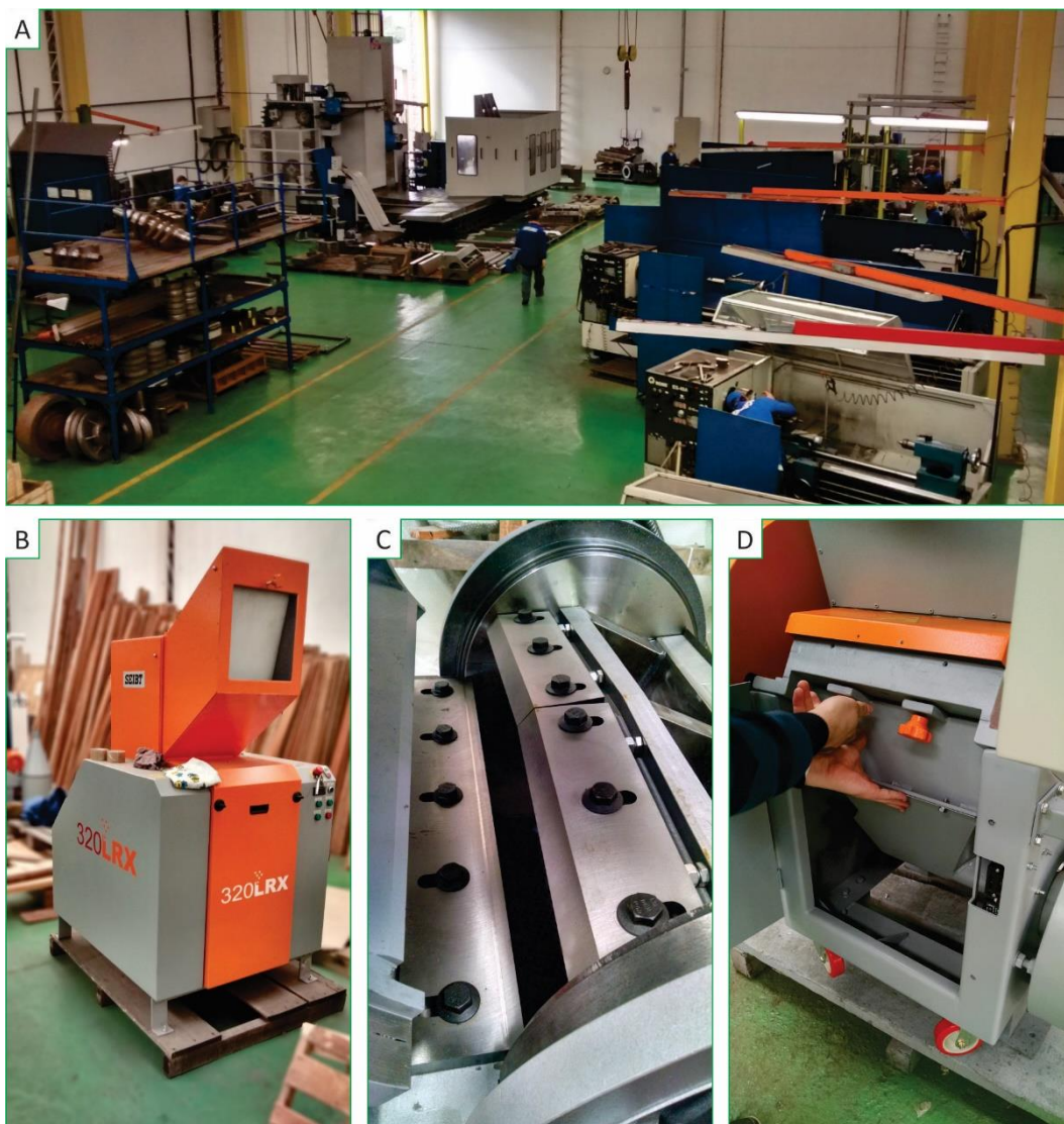
Figura 16 — SEIBT®: (A) indústria, (B) moinho, (C) lâminas e (D) acesso interno
