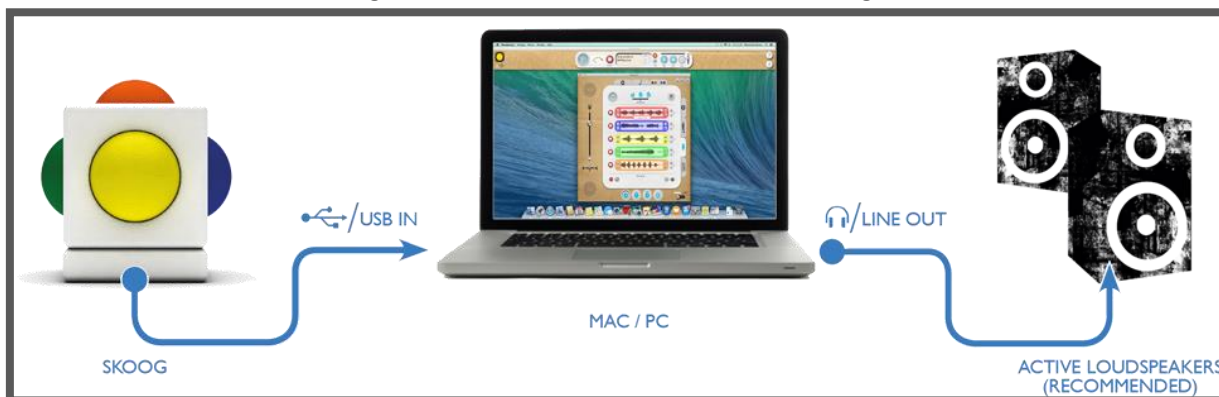
Figura 14: Funcionamento do sistema Skoog
