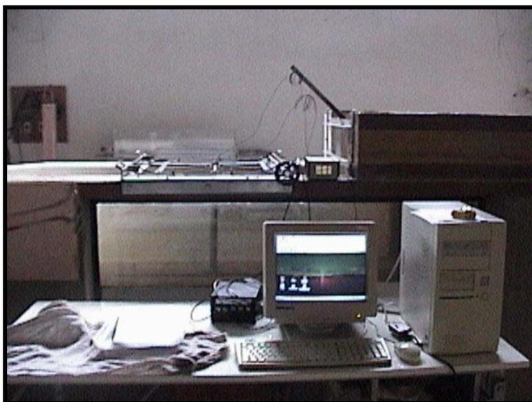
Fig. 4.3 – Vista frontal da seção de testes com a parede de vidro. Na foto podem ser vistos os equipamentos usados no sistema de aquisição de dados bem como um dos cilindros ensaiados.
