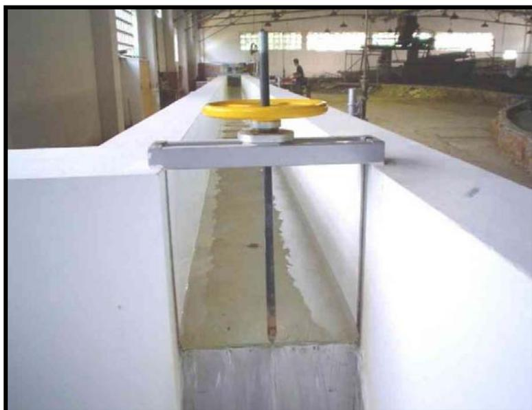
Fig. 4.4 – Comporta para controle do nível no canal.
