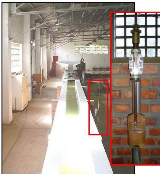
Fig. 4.21 - Ponteira linimétrica utilizada para medir níveis, extraído de Romagnoli (2005).
