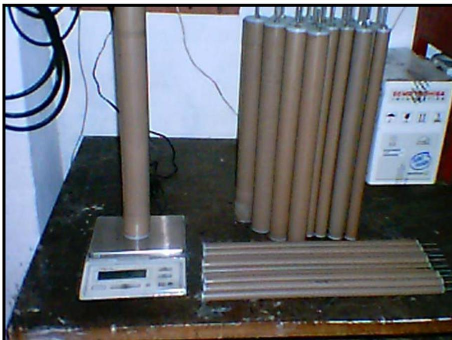
Fig. 4.13 - Pesagem dos cilindros.
