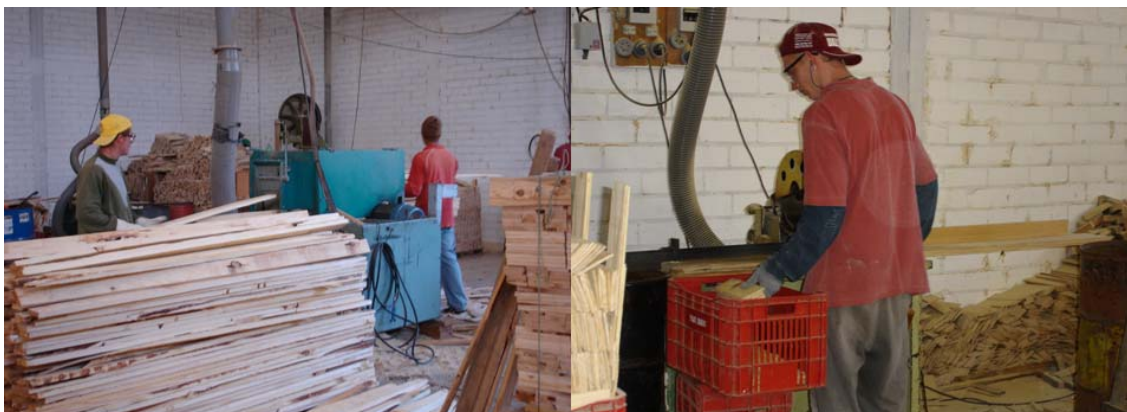
Figura 4.8 Refilo sendo serrado em 3 partes e posteriormente cortado nas dimensões da caixa.
