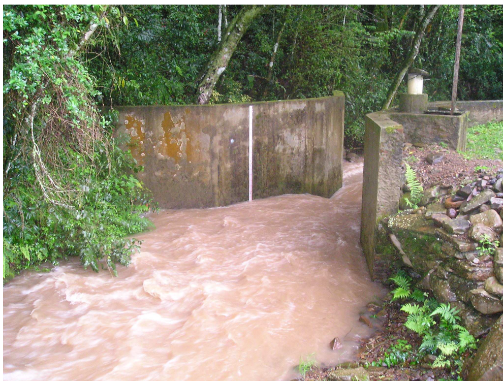
Figura 5.10. Calha parshall instalada no exutório da bacia de Arvorezinha para a medição da vazão.
