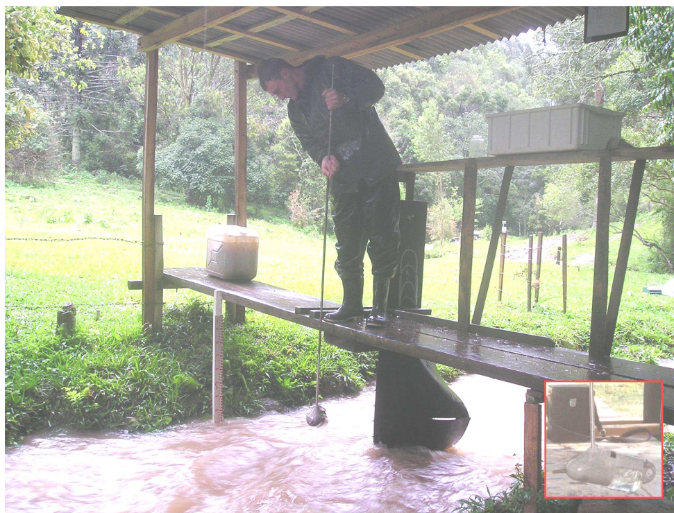
Figura 5.11. Método de amostragem para a determinação da concentração de sedimentos em suspensão com amostrador USDH-48.
