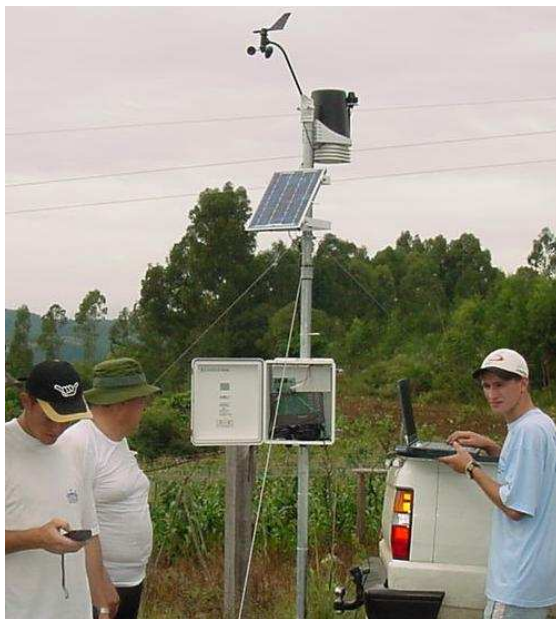
Figura 5.7. Estação meteorológica e pluviógrafo na bacia experimental de Arvorezinha.
