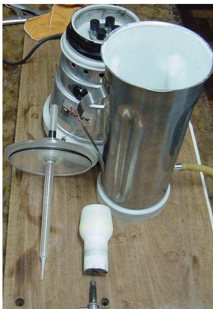
Figura 5.16. Centrífuga de fluxo contínuo para separar o material sólido e fino da fase aquosa da amostra.
