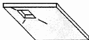
Quadro 6.3 Casos de fissuras em torno de aberturas em lajes
