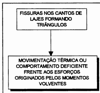
Figura 4.12 Árvore de decisão representativa de lajes com fissura nos cantos
