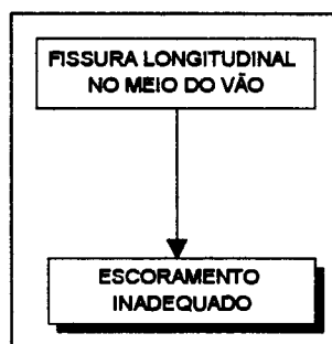
Figura 4.18 Árvore de decisão representativa de lajes em balanço com fissura longitudinal, na face inferior e no meio do vão
