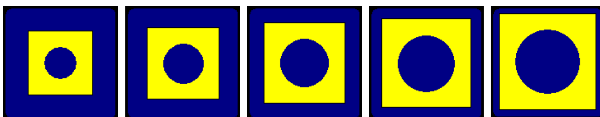
Figura 4.4: Dilatação superficial – chapa com orifício circular em seu centro submetida a um aumento de temperatura. Na seqüência, da esquerda para a direita, observa-se que, à medida que a barra dilata, o orifício dilata nas mesmas proporções.
