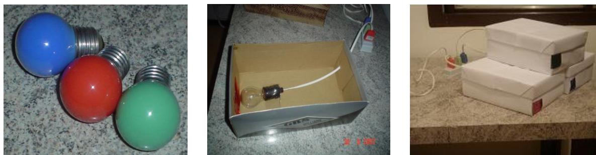
Figura 5.8: À esquerda, são mostradas as três lâmpadas coloridas de 40 W; no centro, a adaptação da lâmpada de 100 W à caixa de papelão, com um orifício tapado com papel celofane colorido; à direita, a montagem das três caixas de papelão com os orifícios tapados com papel celofane nas cores: vermelha, azul e verde.
