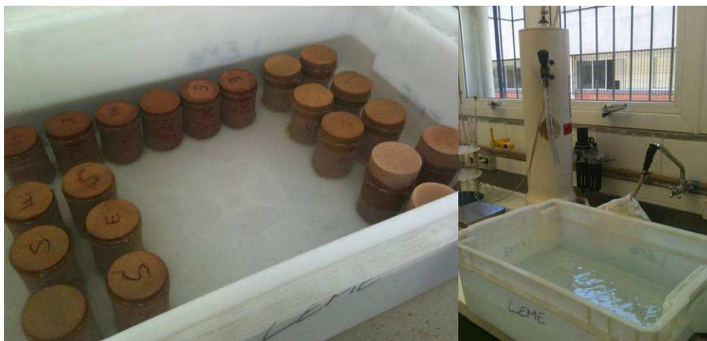
**Figura 37. Amostras dos dois tipos de arenito estudados sendo encharcadas por capilaridade em água deionizada. A direita, filtro deionizante do LEME/UFRGS.**
