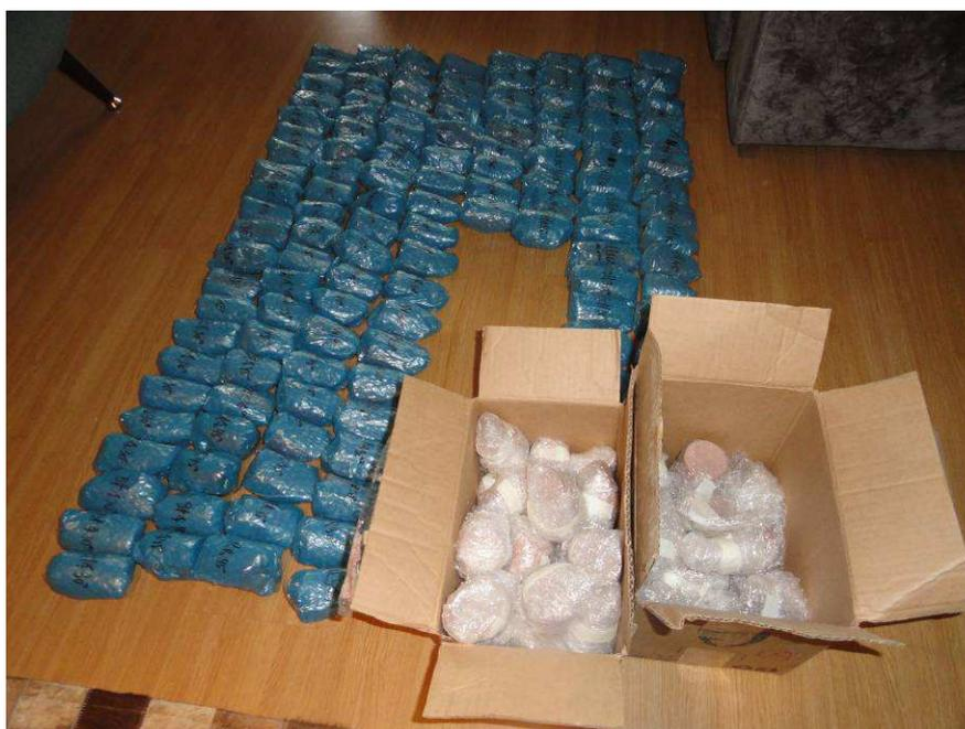
**Figura 36. Conjunto das metades rochosas dos corpos de prova submetidos aos ensaios CCBT. As embalagens azuis, disposta no piso são aquelas provenientes na extração in loco, enquanto as armazenadas nas caixas são aquelas provenientes da extração dos blocos trazidos para o laboratório.**
