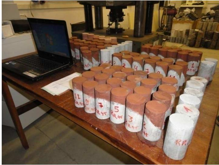
**Figura 44.** Conjunto de amostras que foram rompidas, formando três séries de 24 corpos de prova. Observa-se também os seis corpos de prova de nata de cimento moldados para cada serie também prontos para serem ensaiados.
