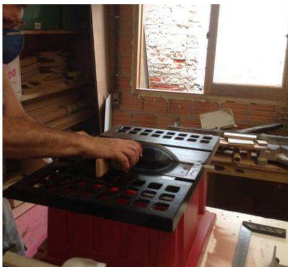
**Figura 30. Máquina de bancada, com disco diamantado, utilizada para o corte das amostras.**
