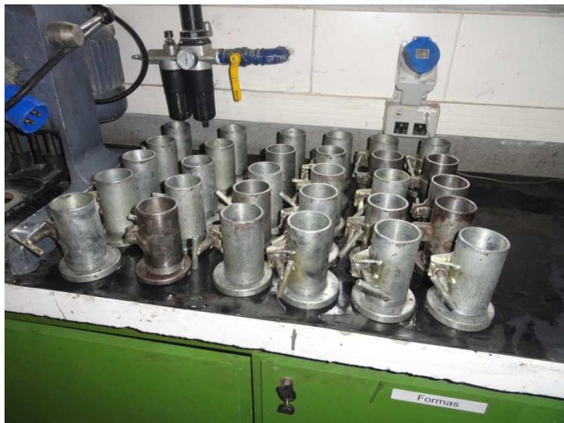
**Figura 41. Conjunto com 30 moldes sendo 24 moldes para a formatação dos corpos de prova do ensaio CCBT e outros 6 moldes para a verificação da resistência a compressão simples da nata de cimento.**
