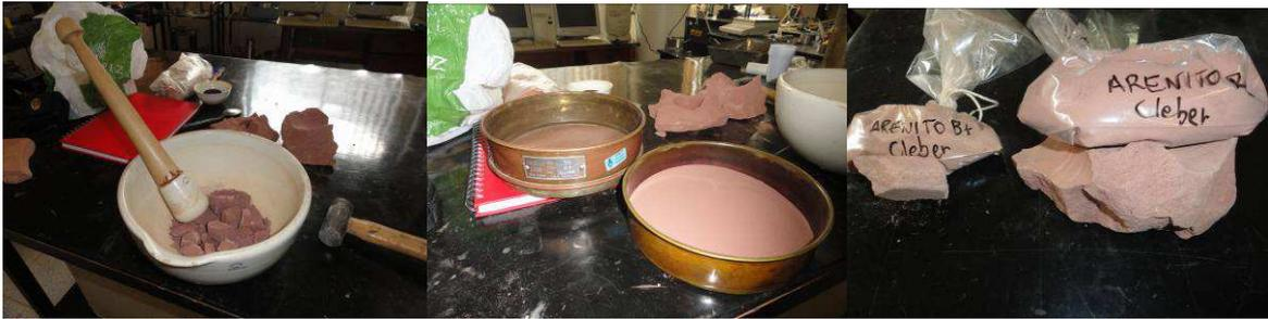
**Figura 38.** Apiloamento e peneiramento pela malha número 30 e armazenamento do material para classificação.
