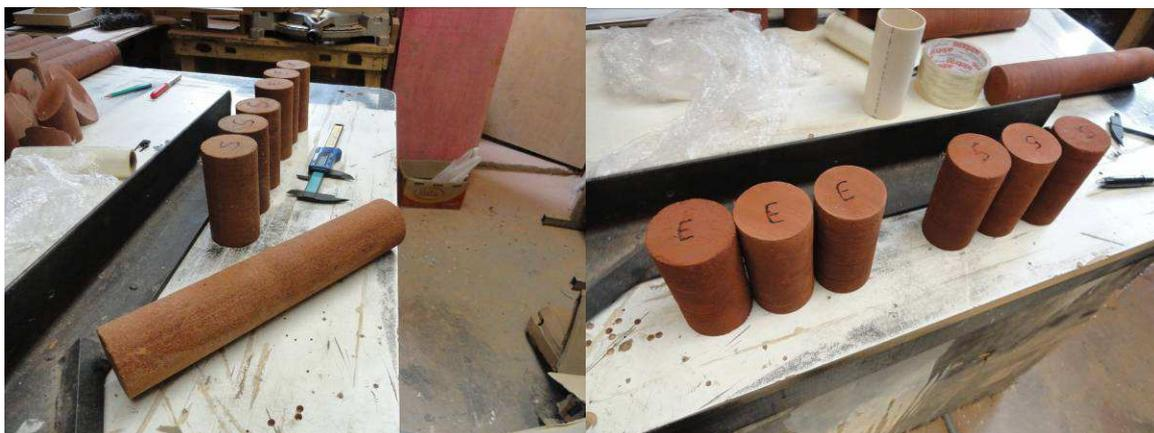
**Figura 31. Exemplo de preparo de corpos de prova cilíndricos para ensaio de compressão simples. Neste caso, o material é o arenito Rio do Rastro. Estes CPs apresentam altura em média de 100mm e diâmetro de 50mm. Observa-se a marcação identificando entrada (E), posição mais superficial no talude e saída (S), indicando a posição mais profunda da amostra.**
