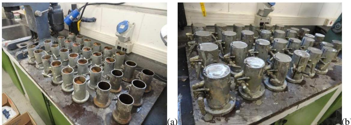
**Figura 42. Posicionamento da parte rochosa dentro do molde metálico (a) e preenchimento com nata de cimento (b).**
