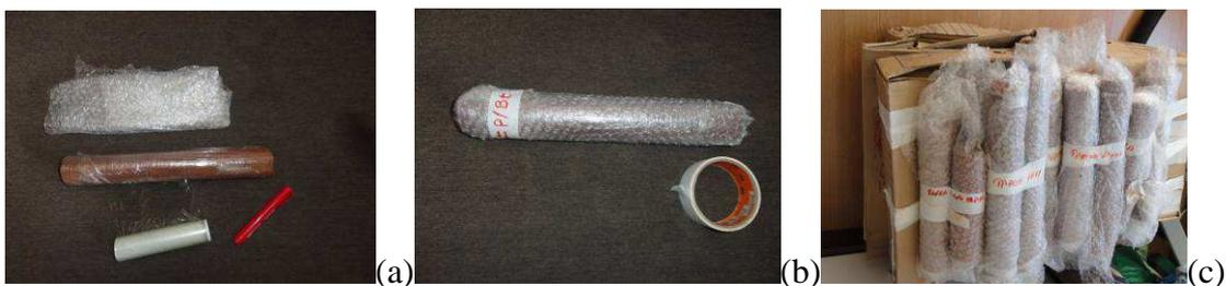
**Figura 29.** A sequência de imagem, a, b e c mostra a ordem executiva para o armazenamento das amostras de rocha extraídas. Observam-se na imagem (a) os materiais necessários para vedação e proteção mecânica de cada amostra cilíndrica (filme PVC, plástico tipo bolha, caneta marcador permanente). A imagem (b) destaca-se a etiquetagem individual da amostra demarcada com fita tipo crepe. A imagem (c) mostra o armazenamento em conjunto identificando o local de extração.
