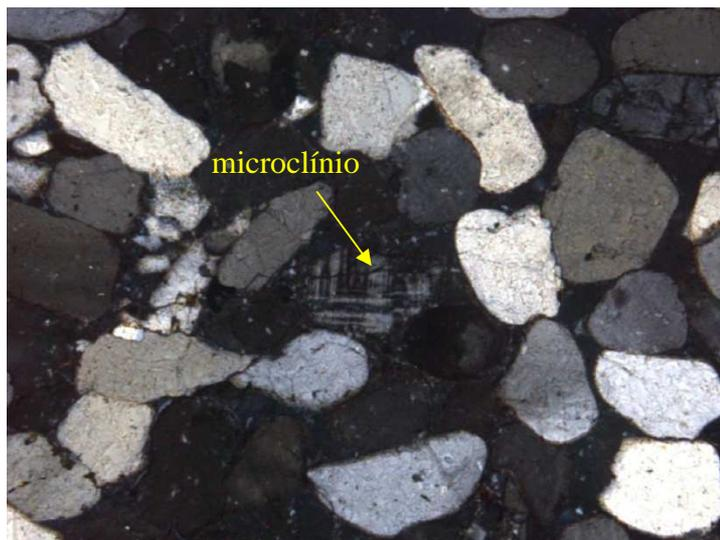
**Figura 72. Composição detrítica da rocha sedimentar, mostrando o detalhe no centro do feldspato microclínio. Imagem obtida através de nicóis cruzados.**
