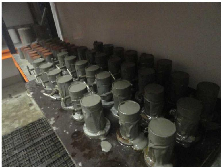
**Figura 43. Cura dos corpos de prova em câmara úmida. Observa-se ao fundo um conjunto de corpos de prova já desmodados.**
