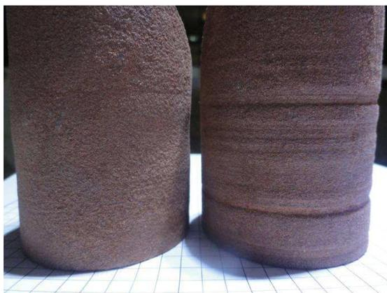
**Figura 26. Imagem comparativa entre uma amostra com corte regular no lado esquerdo e uma amostra com variações diametral devido à variação do controle manual de avanço.**
