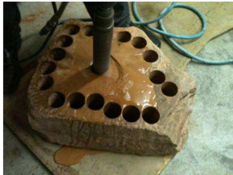
**Figura 27. Extração de amostras em blocos remanescentes de rupturas. A imagem mostra a extração de amostras do bloco de arenito eólico da Formação Botucatu.**
