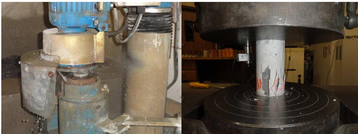
**Figura 46. (a) máquina retificadora de corpos de prova de concreto e nata de cimento do LEME-UFRGS retificando um dos corpos de prova que foram submetidos a compressão simples. (b) ruptura do corpo de prova cilíndrico com dimensões de 100mm de altura por 50mm de diâmetro.**
