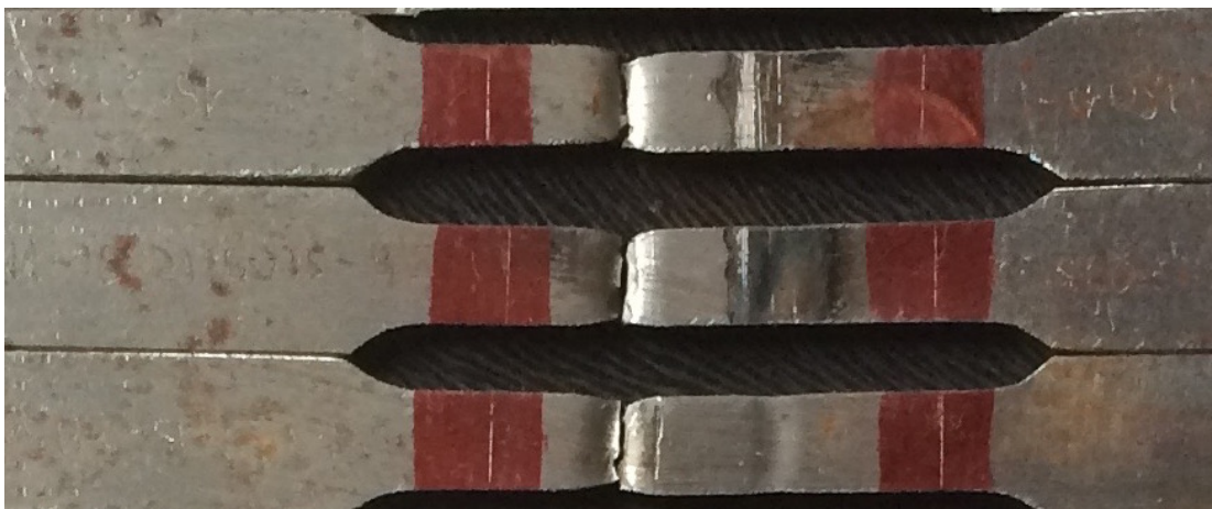
Figura 36: Copos de prova com fratura dúctil.
