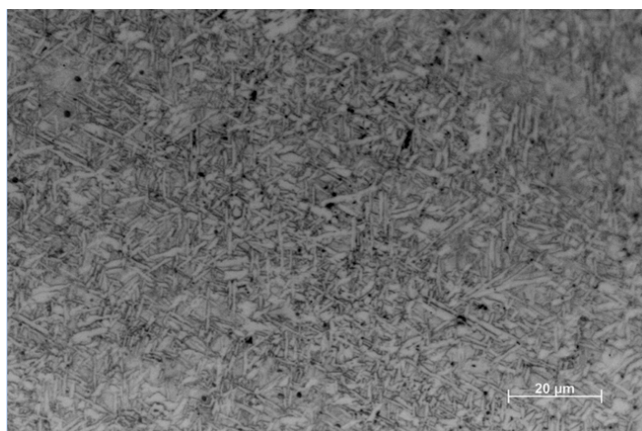
Figura 29: cordão de solda 3st. Microestrutura de martensita e bainita com pequenos grãos de ferrita acicular dispersos.
