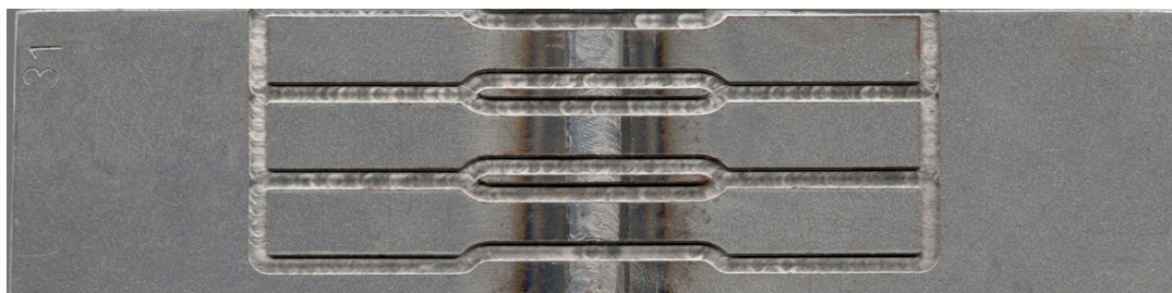
Figura 15: Chapa com desenho da usinagem.
