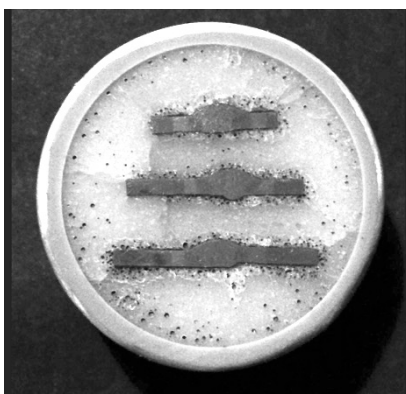
Figura 16: Cordões de solda embutidos em resina acrílica.
