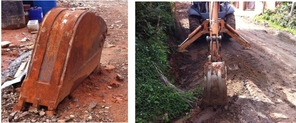
Figura 21 e 22 – À direita, concha de 40 cm armazenada no canteiro e à esquerda, a concha já instalada e trabalhando na frente de serviço
