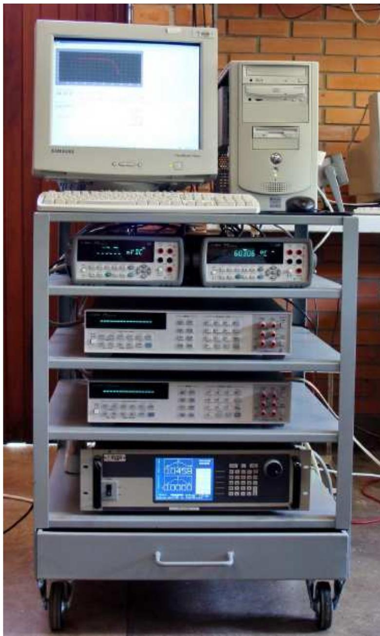
Figura 5.3 – Sistema de medição de curvas características de módulos fotovoltaicos utilizado no LABSOL. Fonte: Gasparin, 2009.
