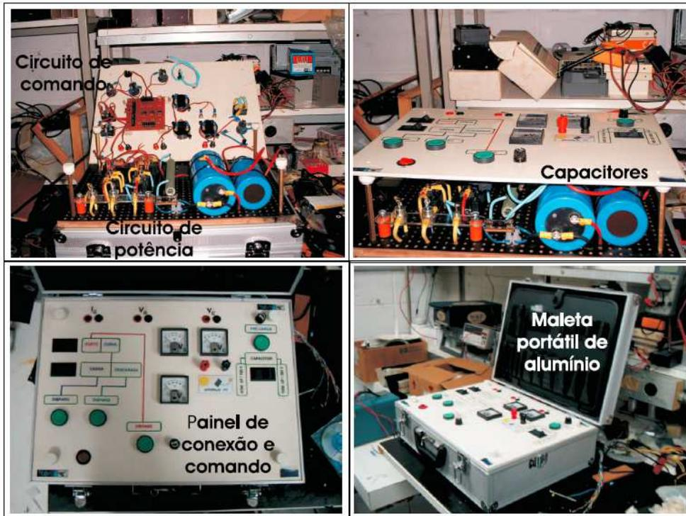
Figura 3.6 - Carga capacitiva construída no IEE/USP. Fonte: Macêdo, 2006.
