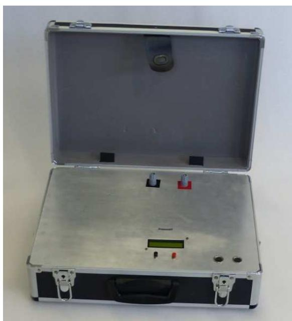
Figura 4.16 – Painel de controle do protótipo.
