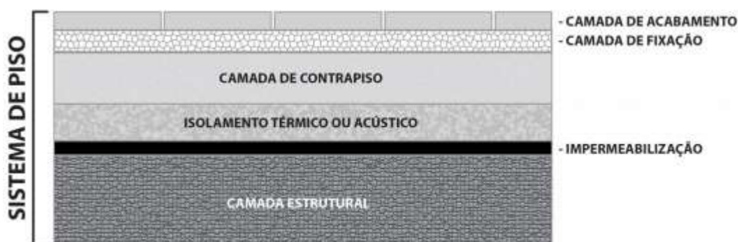
Figura 1- Exemplo genérico de um sistema de pisos e seus elementos. Fonte: NBR 15575-3 (ABNT, 2013)
