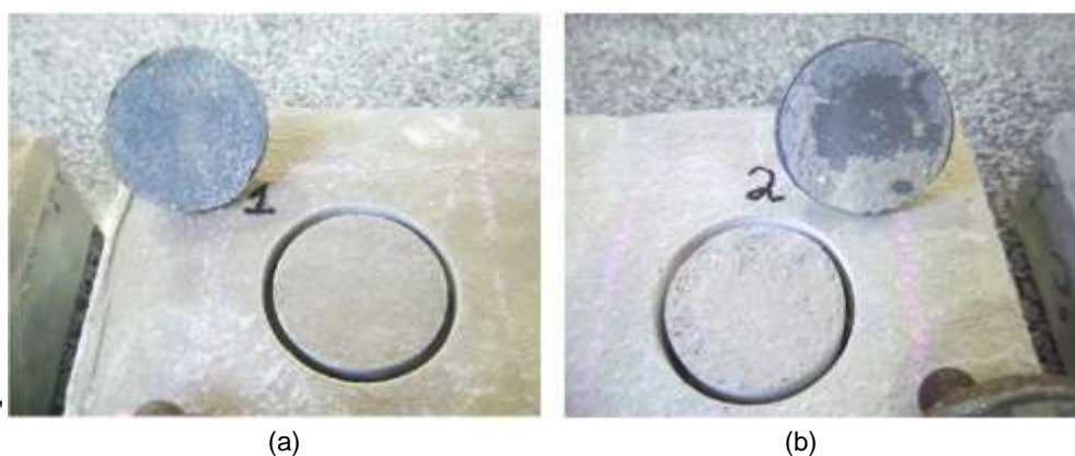
Figura 68 - Problemas com a cola epóxi. (a) Falta de ancoragem entre a pastilha e a argamassa. (b) Extração equivocada do corpo-de-prova.
