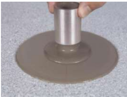
Figura 43 - Equipamento indicado pela ASTM C1708 (2012) para a realização do o ensaio de retenção de fluxo. Fonte: Guimarães (2013)
