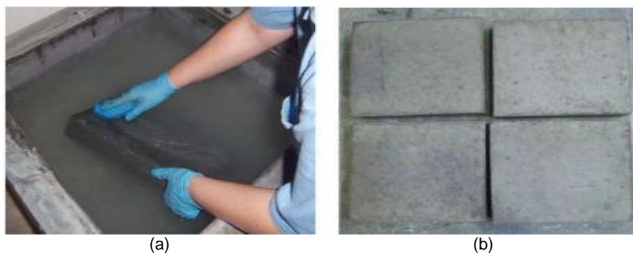
Figura 30 - Placas de concreto utilizadas como substrato: (a) Lavagem da placa de concreto; (b) aspecto das placas após secagem
