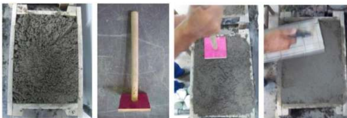
Figura 37 - (a) Enchimento dos moldes com argamassa farofa; (b) pilão de madeira confeccionado; (c) apiloamento da argamassa farofa sob a placa de concreto; (d) desempenho da argamassa farofa
