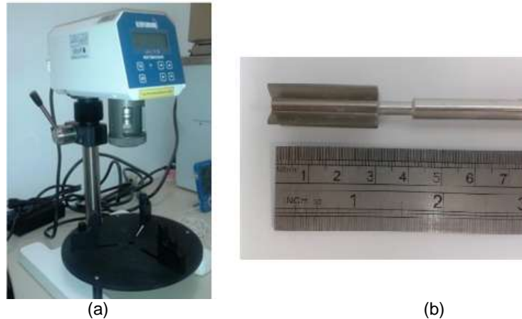
Figura 45 - Aparelhagem utilizada para a reometria rotacional (a) Reômetro do modelo Brookfield R/S plus; (b) palheta do tipo vane V (30x15mm).
