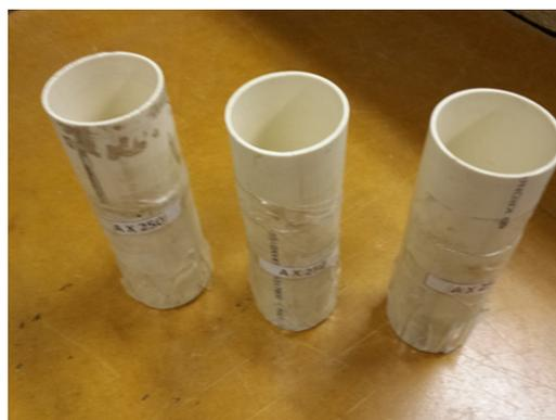
Figura 3-4: Foto dos moldes com tubo de PVC
