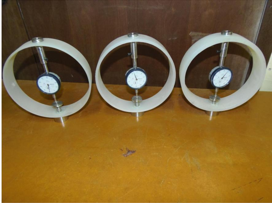
Figura 3-1: Fotos dos anéis dinamométricos de nylon
