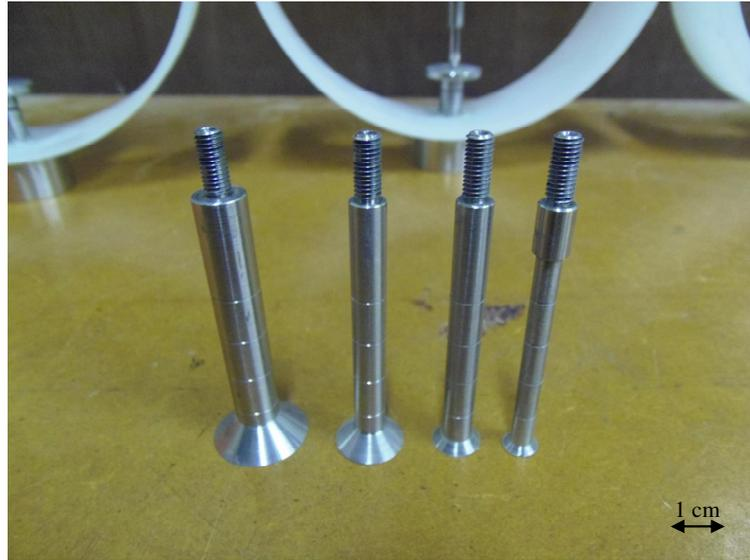
Figura 3-2: Foto da vista lateral das ponteiros com base alargada
