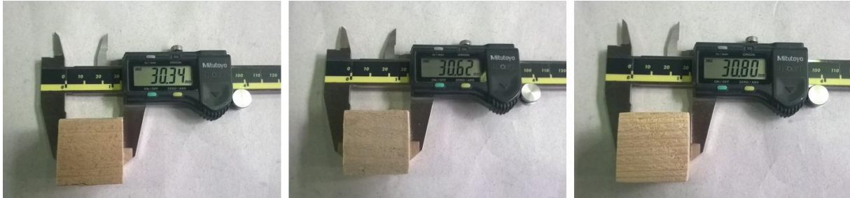
Figura 28: Dimensões dos espaçadores ( 30 \pm 1 mm).
