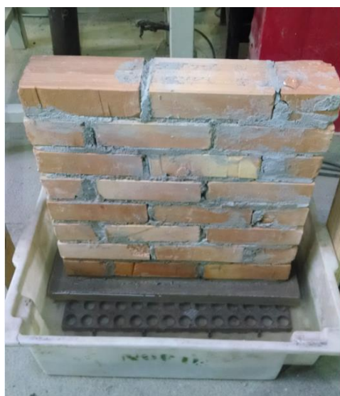
Figura 55 – Corpo de prova colocado imerso dentro de água, o qual fica em contato apenas com a argamassa.
