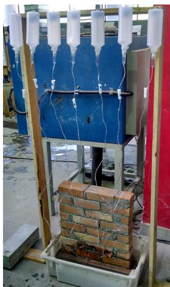
Figura 52 – Dispositivos para aplicação do cristalizante nos furos realizados.
