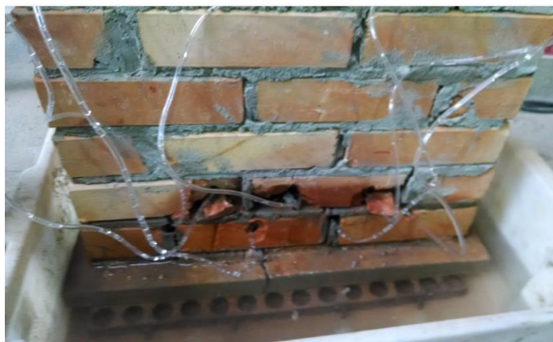
Figura 57 - Corpo de prova logo após a aplicação do produto cristalizante nas perfurações.
