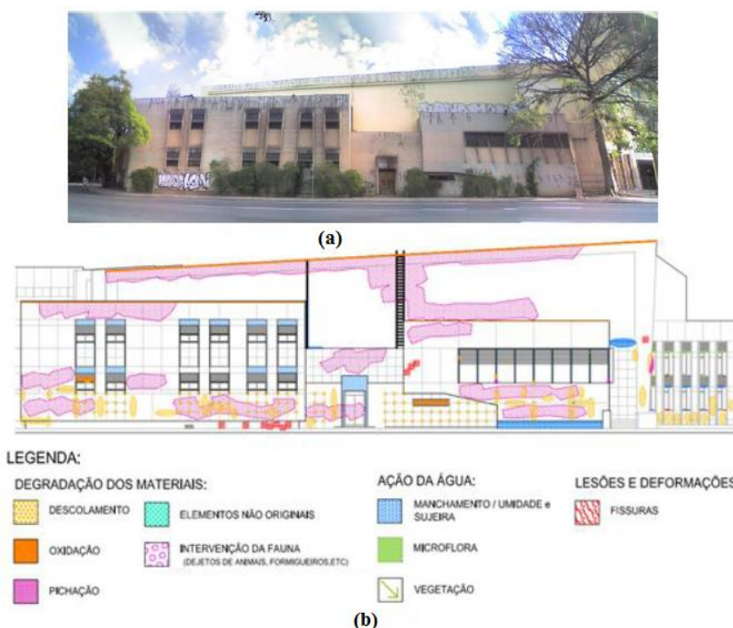
Figura 17 - Levantamento não destrutivo realizado no edifício do Salão de Atos da UFRGS: (a) imagem digital da vistoria realizada, (b) mapeamento de danos. Adaptado Rubin et al. (2014).
