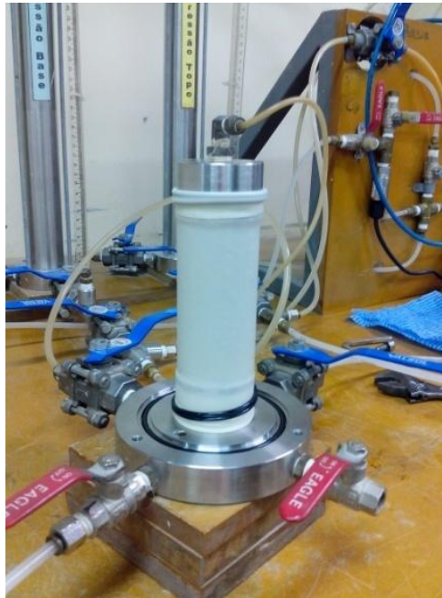
Figura 3.7: instalação da amostra a ser ensaiada na câmara.
