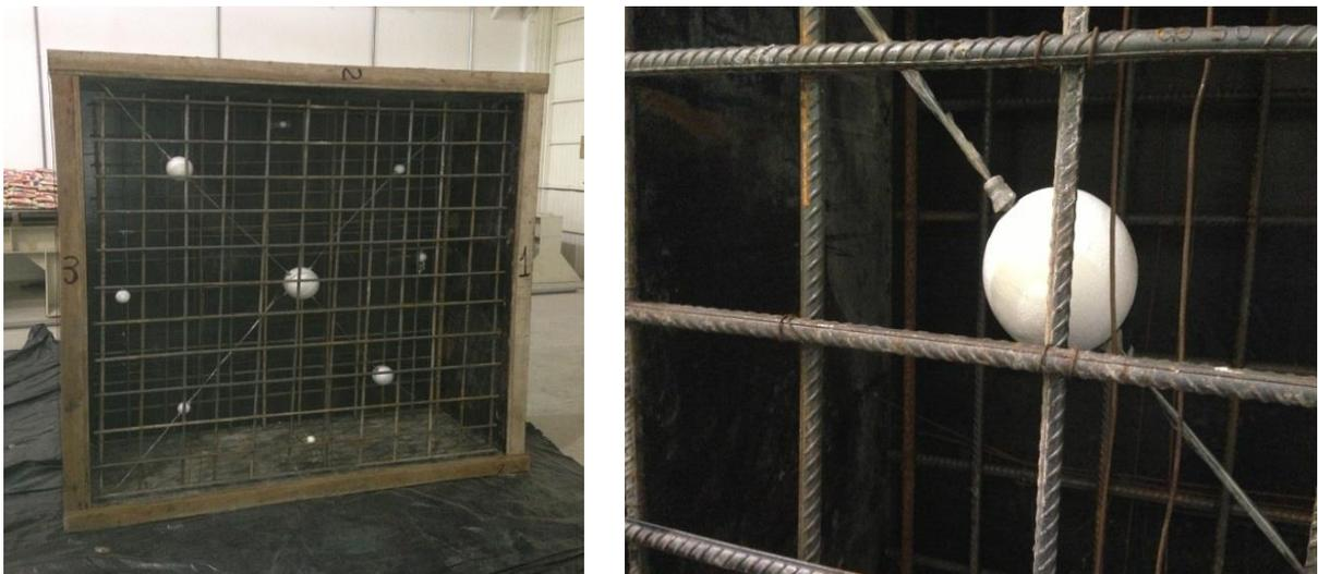
Figura 25 – Fôrma da parede 2 com vazios.
