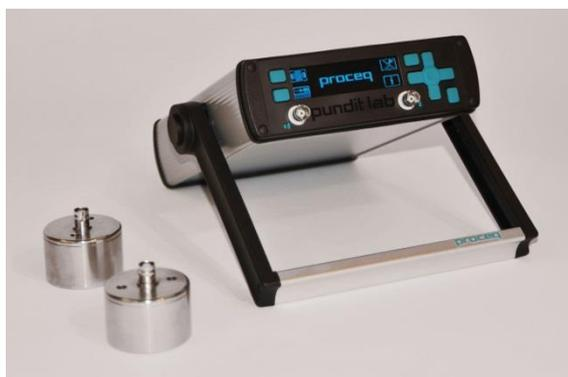
Figura 22 – Equipamento de Ultrassom utilizado.
