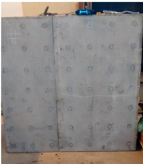
Figura 28 – Elemento marcado com as posições dos transdutores.
