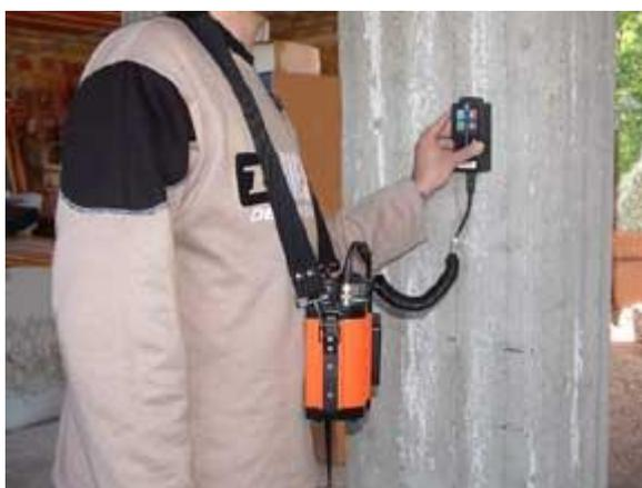
Figura 2 - Execução do Ensaio de Pacometria (SANTOS (2008)).
