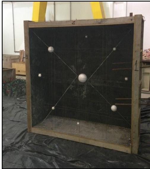
Figura 24 – Fôrma da parede 1 com vazios.
