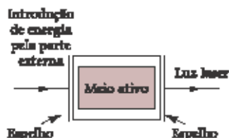
Fig. 11. Esquema simplificado das partes que constituem um laser.
