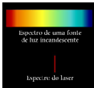
Figura 13. Espectro contínuo (vários comprimentos de onda) e espectro discreto do laser (apenas um comprimento de onda).
