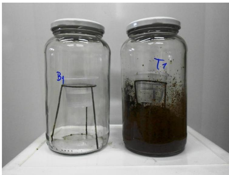
Figura 6. Unidades experimentais do ensaio de respirometria.
