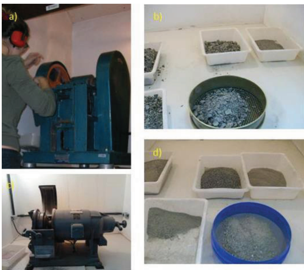
Figura 10: Etapas sucessivas de preparação de amostras. a) Britador; b) peneira < 6mm; c) Moinho; d) Peneira < 500 \mu\text{m} .
