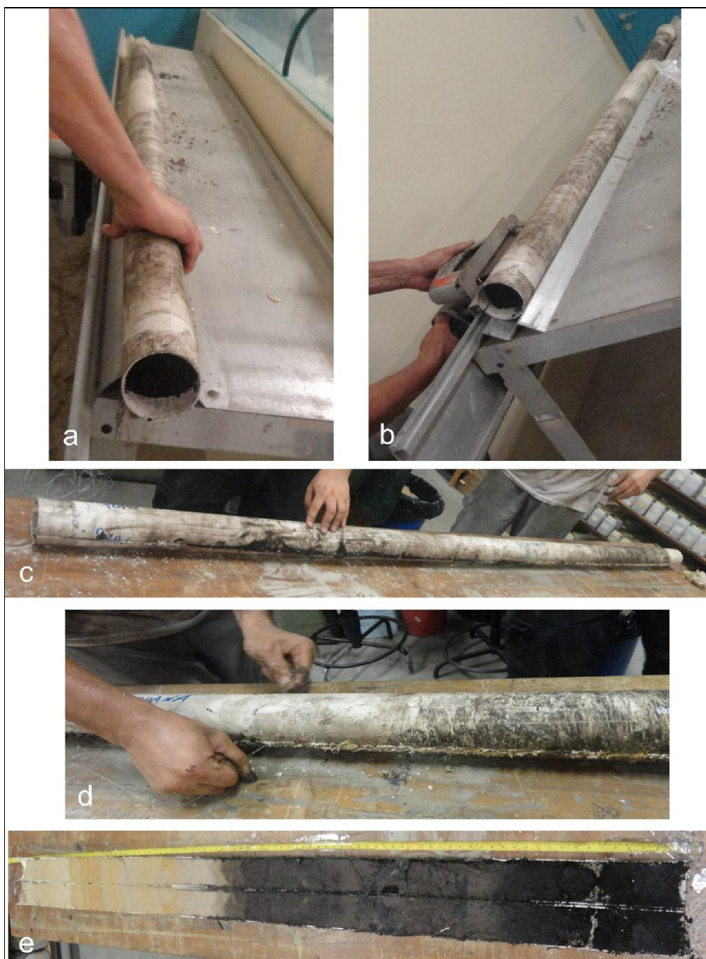
Figura 38: Abertura do testemunho da turfeira de Águas Claras. a) Testemunho em bancada apropriada. b) Utilização de serra circular. c, d) Fio de nylon para dividir o testemunho. e) Testemunho dividido em duas seções longitudinais.
