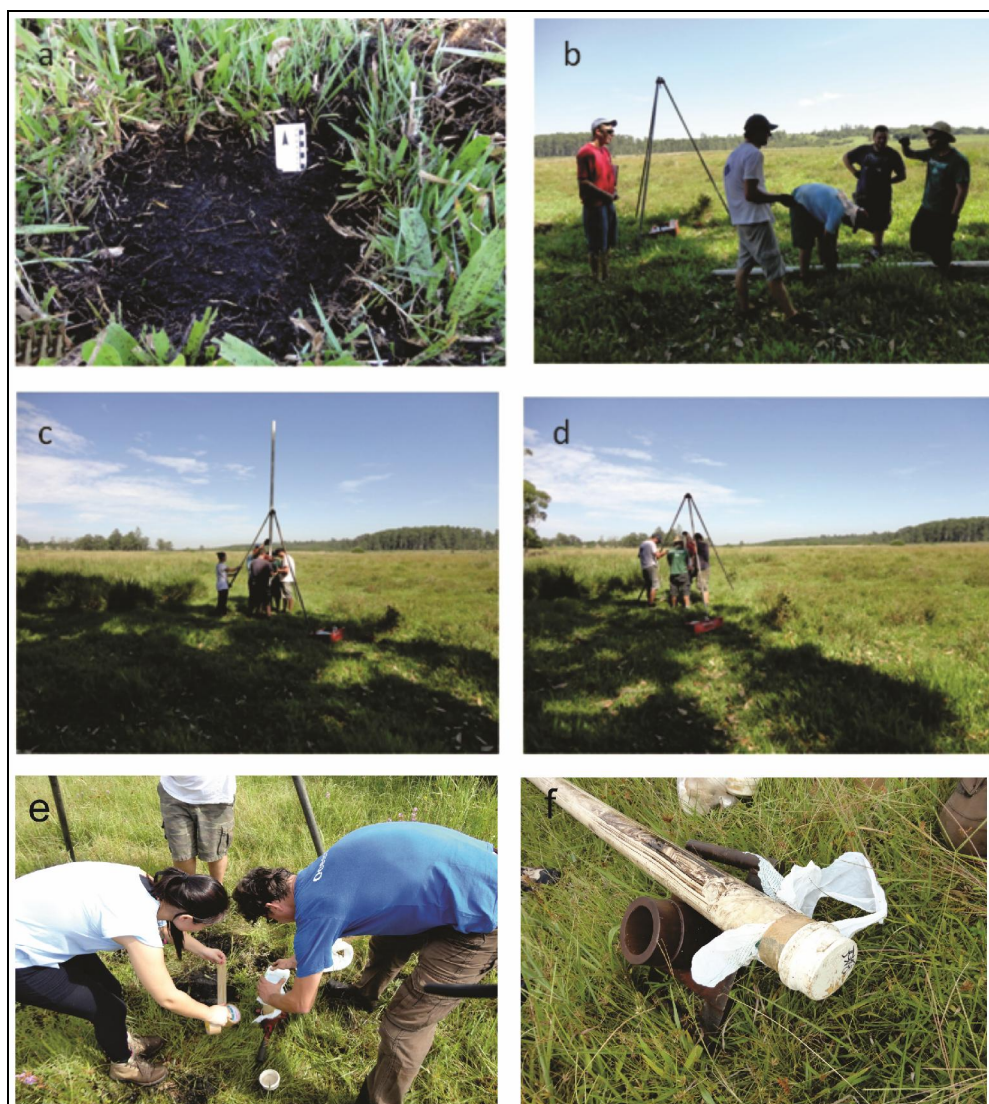
Figura 37: Sondagem na turfeira de Águas Claras. a) Local escolhido para sondagem. b,c,d,e) Técnica de sondagem. f) Testemunho fechado para impedir contaminação.
