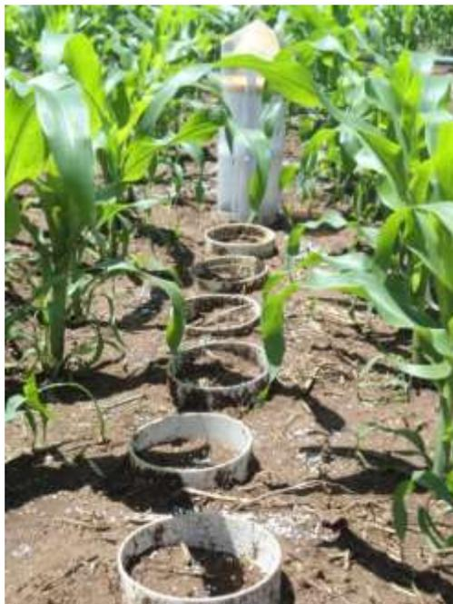
FIGURA 2. Foto ilustrativa do coletor de PVC utilizado nos estudos de volatilização de amônia.
