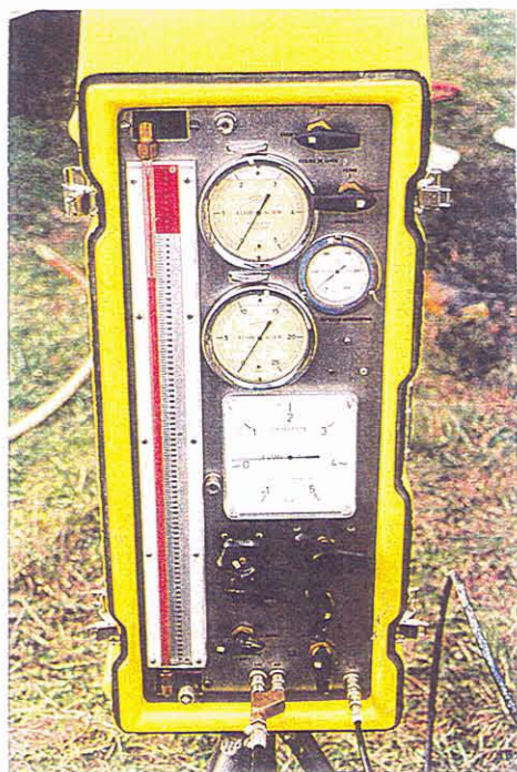
Figura 6.7 - Pressiômetro Ménéard tipo GA a) Vista frontal b) Vista posterior
