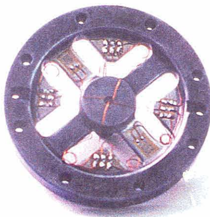
Figura 4.1 - Detalhes de instrumentação de uma célula de carga
