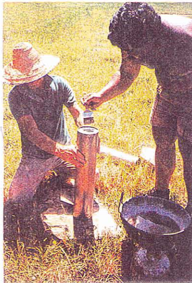
Figura 5.1 - Extração de amostras com tubo Shelby (127 mm)
