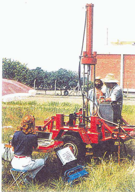
Figura 6.36 - Máquina de cravação desenvolvida na UFRGS
