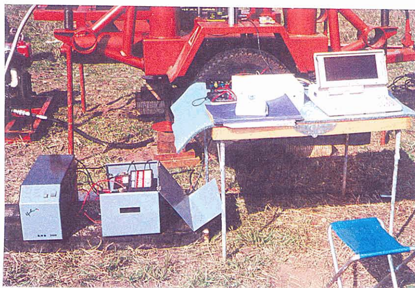
Figura 4.16 - Sistema de aquisição automática de dados de ensaios de cone elétrico
