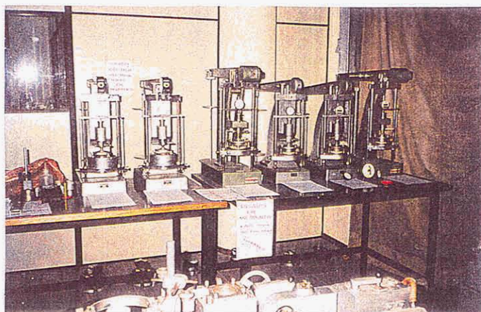
Figura 5.3 - Ensaio de adensamento a) moldagem do corpo de prova b) corpo de prova na célula de compressão c) bateria de ensaios de adensamento
