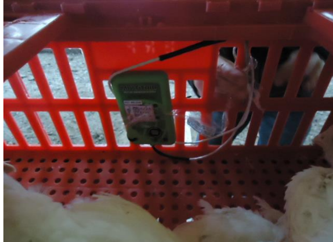
FIGURA 01: Registrador de temperatura sendo posicionado no interior da gaiola.
