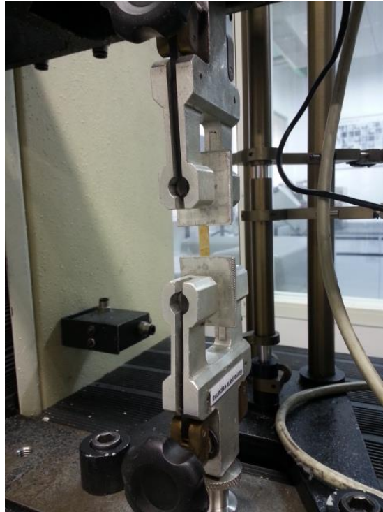
Figura 3. Foto ensaio de resistência à tração (corpo de prova do filme controle).
