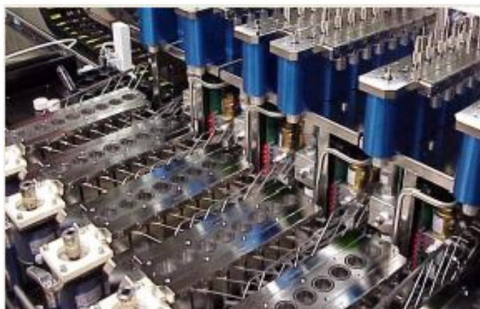
Figura 5. Imagem dos 6 módulos do PPR com os 48 minirreatores 104 .
