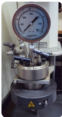
Figura 30. Autoclave com volume interno de 100 mL.
