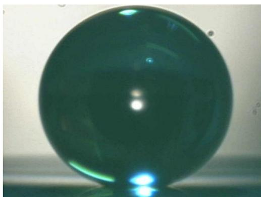
Figura 24. Gota de água depositada sobre a superfície da amostra de Cu+Ag+TMPSi+PTFE. Ângulo de contato estático desta gota:  $166,3^\circ \pm 0,3^\circ$ ; ângulo de contato dinâmico:  $0,9^\circ \pm 0,3^\circ$ .
