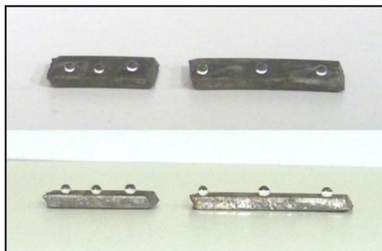
Figura 36. Gotas de água sobre as amostras após a regeneração.
