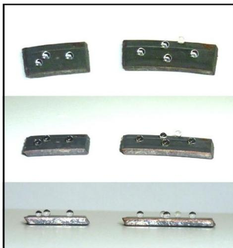
Figura 34. Gotas de água sobre as amostras de Cu+Ag+TMPSi antes do teste de regeneração.
