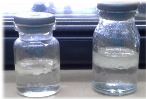
Figura 12: Formação de grumos sobre a fase aquosa contendo óleo de soja e PAMAM G2,0 (esq.) e mistura de óleo e água (dir.).
