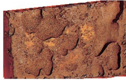
Corrosão em placas
