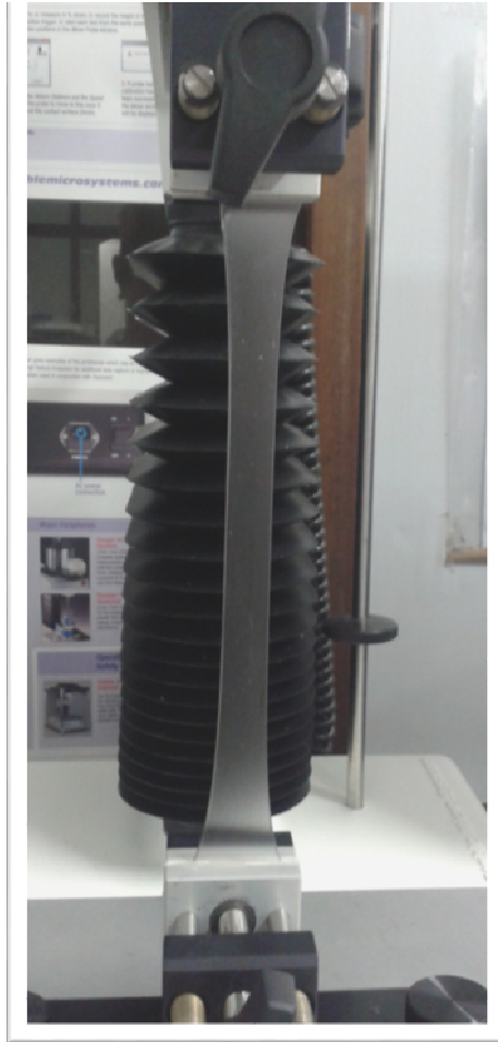
Figura 8 - Análise das propriedades mecânicas dos filmes realizada em texturômetro.
