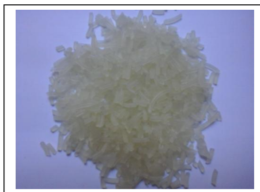
Figura 9: Pellets de amido/glicerol/EPI/água (TPSR) obtidos por extrusão.
