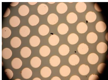
Figura 29 - Amostra vista ao microscópio óptico após realizar deposição dos contatos de Al.
