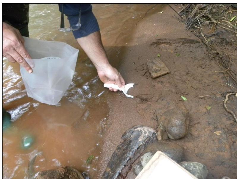
Figura 9. Amostragem de sedimento ativo de drenagem em campo usando materiais de plástico para não haver contaminação.
