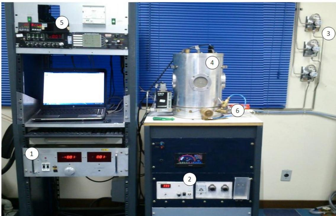
Figura 3.1: Fotografia do sistema de nitretação a plasma: ① fonte de tensão DC; ② fonte de tensão RF; ③ entrada de gases; ④ câmara principal; ⑤ controladores de fluxo e medidores de pressão; e ⑥ válvulas.
