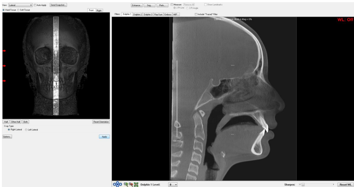
Figura 5 – Definição da espessura da reconstrução tomográfica (imagem à esquerda) e reconstrução tomográfica gerada (imagem à direita)
